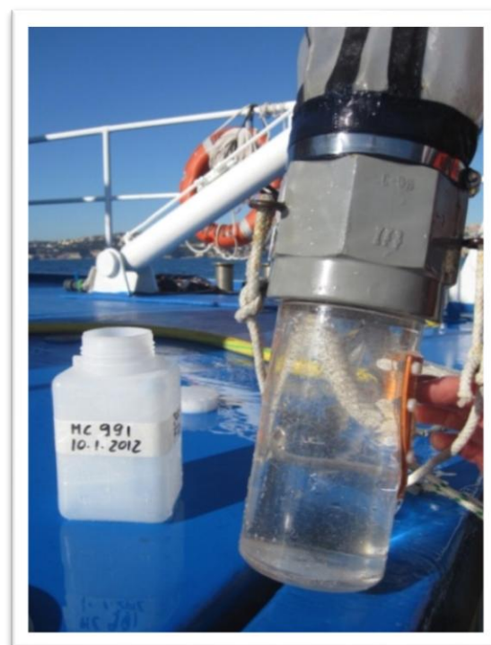
Figura 2 - Collettore applicato al fondo della rete barattolo per la raccolta del campione di zooplancton.
