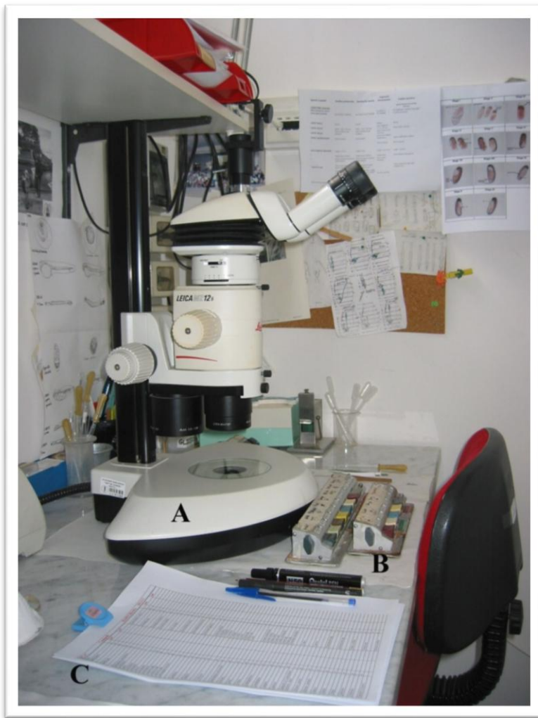
Figura 4 - Stereomicroscopio, contatori meccanici e scheda di conteggio cartaceo.
